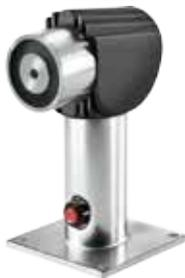
Retenedor de pared de 400N, con soporte abatible a 90° (300 mm) para suelo o 180° (325 mm) para pared. Cabeza giratoria de plástico reforzado con fibra de vidrio y pulsador de desbloqueo rojo. El equipo libera la puerta cuando se deja de aplicar la tensión de 24Vcc. Incluye diodo de protección y polarización y placa ferromagnética articulada Ref. 960110.
